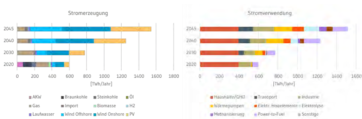
Abbildung 7.1: Stromerzeugung und -verwendung im Szenario Technologiemix (REMod).
